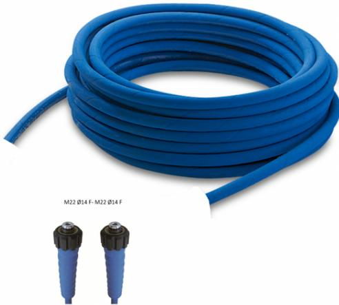
Ce flexible HP bleu, renforcé de deux tresses en acier, est conçu pour une utilisation dans les **milieux alimentaires** où une **résistance accrue aux corps gras** est nécessaire. Il est équipé de deux raccords à visser manuels pour une installation facile et sans outils. Ce flexible peut être utilisé avec de l'eau froide ou chaude jusqu'à une température de **150°C**, ce qui le rend **polyvalent** pour une large gamme d'applications. De plus, sa souplesse le rend moins fragile à l'écrasement.
